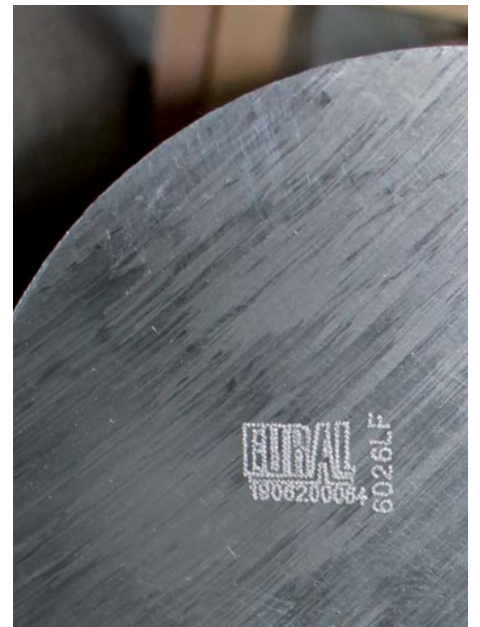
Stampigliatura di logo Eural, codice lega e lotto di produzione su tutte le barre estruse
